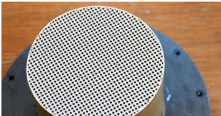
Keramikfilter eignen sich wegen der Wartung für den Einsatz in Lüftungssystemen. Viren werden zurückgehalten und verlieren innerhalb von 48 Stunden ihre Aktivität.
