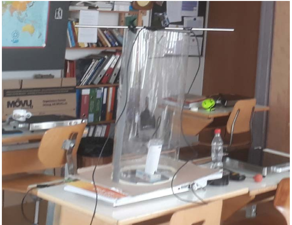
Mit dem Nebulizer werden Kochsalzpartikel versprüht. Damit werden die Wirkungsweise und die Ausbreitung von Aerosolen im Raum simuliert.
